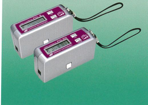
PG-II/IIIMは、JIS・ISO、ASTM、DINなど各種工業規格の光沢度測定方法に準拠した、軽量・コンパクトで持ち運びが可能なハンディ型光沢計です。PG-IIは20°・45°・60°・75°・85°のいずれか単角度を測定、PG-IIIMは20°・60°・85°の3角度の光沢を同時に測定できます。なお、本器は、RS-232CインターフェイスでPCなどの外部接続装置から遠隔操作し、ラインセンサとして利用することも可能です。
